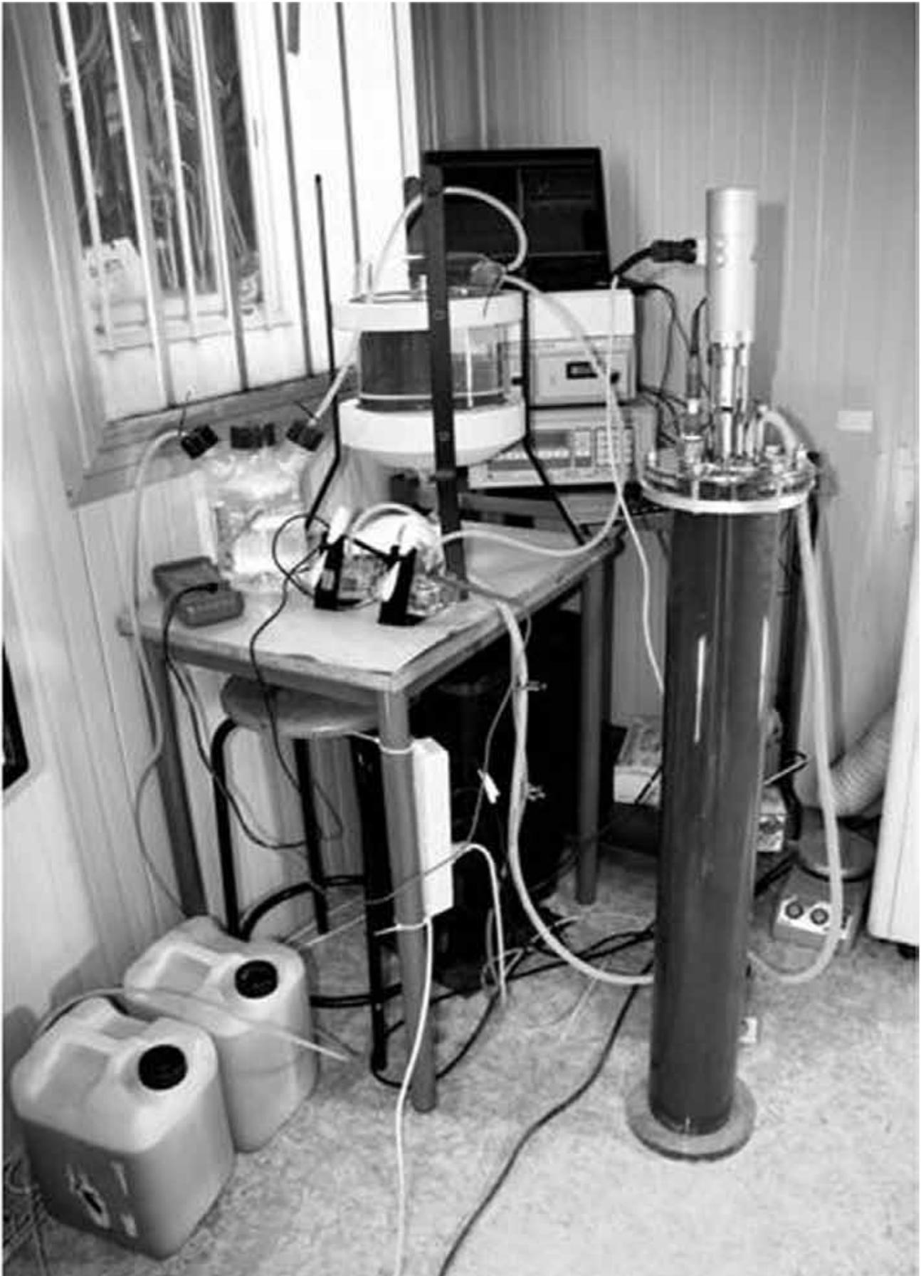
FOTO 11 : Fotobioreattore in produzione di idrogeno su fermentato vegetale
