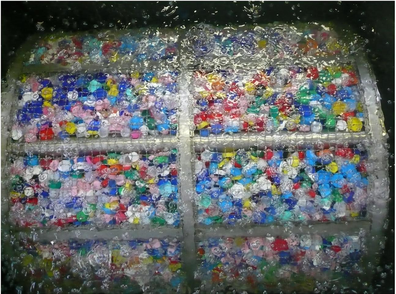
FOTO 23 : Cestello RCBR riempito con i carrier costituiti da tappi di plastica riciclati.
