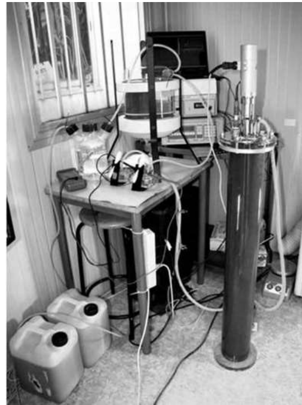
Fotobioreattore in produzione di idrogeno su fermentato vegetale
